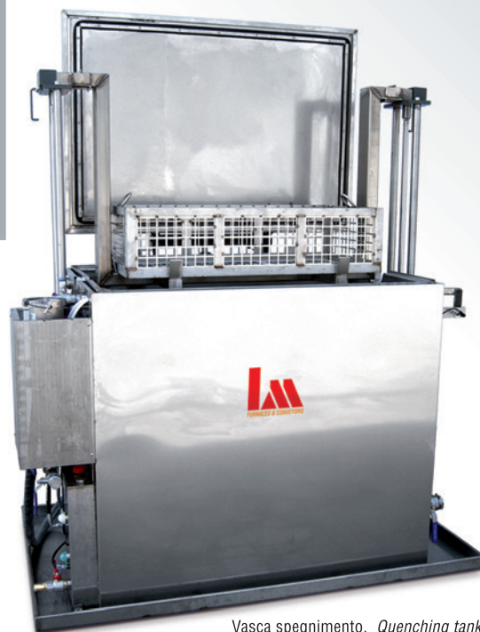
Vasca spegnimento. Quenching tank.
